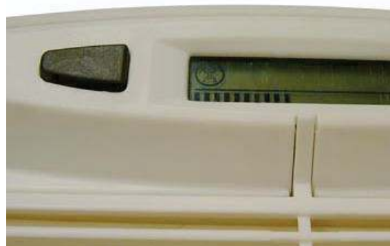
Množství čerstvého venkovního vzduchu se nastavuje pomocí tlačítek na horní straně přístroje.
